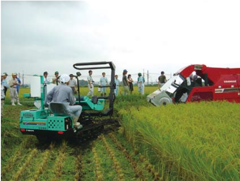
湿った水田で収穫し易い飼料用イネの専用の機械 (左：ラッパー、右：収穫機)が開発されています。
