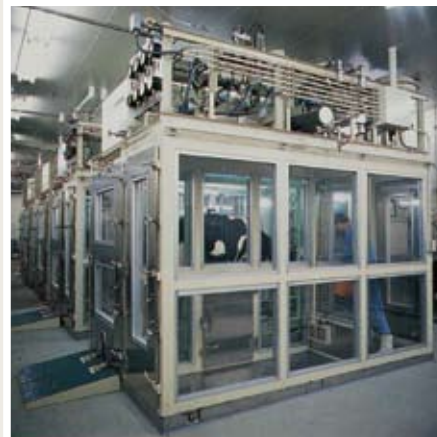
牛用呼吸試験装置を用いた飼養試験
