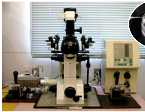
倒立型顕微鏡に取り付けられた マイクロマニピュレーター
