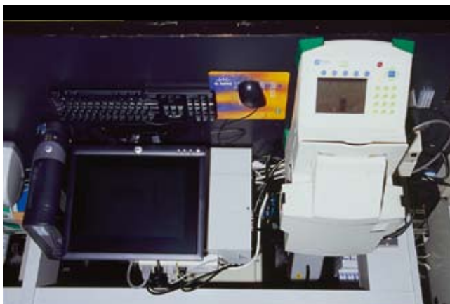
写真1：リアルタイムPCR法 リアルタイムPCR装置。PCR法より迅速だけでなく試料中の遺伝子の量を定量的に測定できる(図1)。
