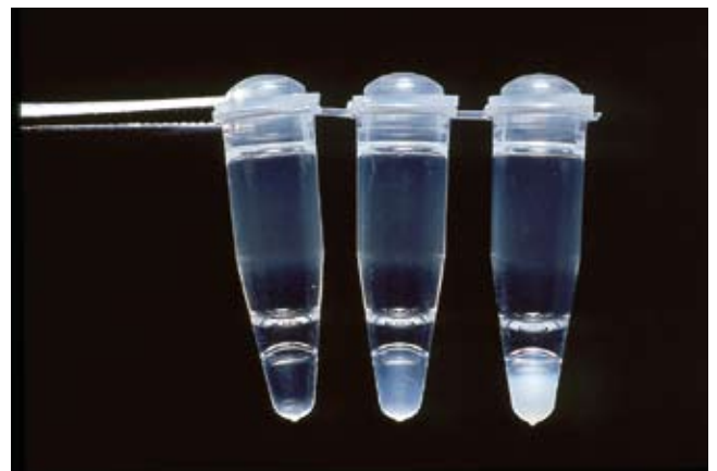
写真2：LAMP法 DNAの増幅とともに液が濁ってくる。肉眼でも結果を判定でき、測定器を使えば定量的な測定もできる。
