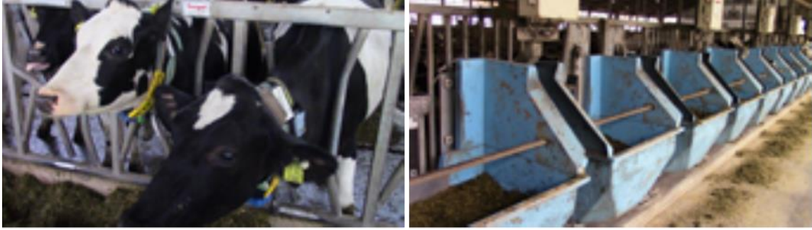
(写真10：搾乳牛のネックベルト各種センサー(左)・採食量計測器(右))
