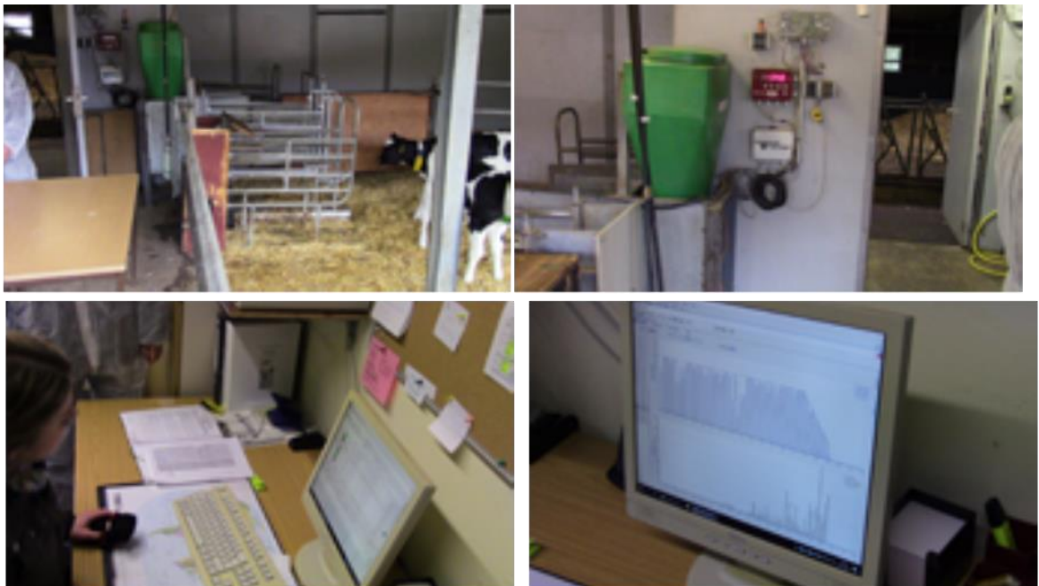
(写真11：自動哺乳・濃厚飼料・飲水装置(左上)・壁の装置で乳、濃厚飼料、飲水の管理(右上) 管理舎内の管理用PC(左下)とモニター(右下：哺乳量が表示されている))
