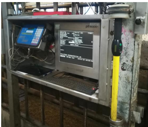
SKARE 社の食肉加工処理場における IC タグスキャンシステム活用の様子
