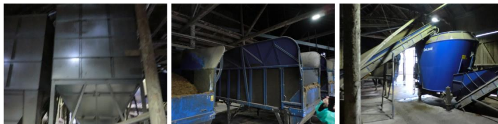
写真3：PMR自動調製システム：左＝濃厚飼料タンク、中＝粗飼料ワゴン、右＝ミキサー ※設定した量の濃厚飼料、粗飼料が自動計測でミキサーに運ばれ、ミキシングの後にベルトコンベアで搾乳牛舎飼槽へ運ばれる
