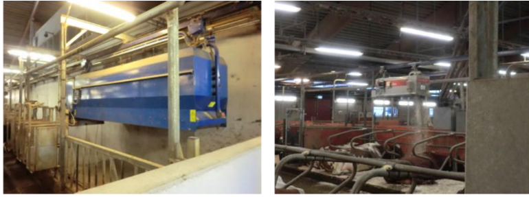
写真1：搾乳牛舎内自動化機器（自動給餌機（左）・自動敷料輸送機（右））
