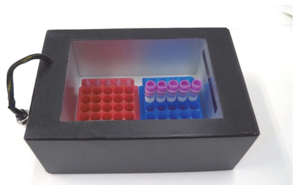
図VII-4 恒温槽内部 恒温槽に 1ml チューブを立てた様子
