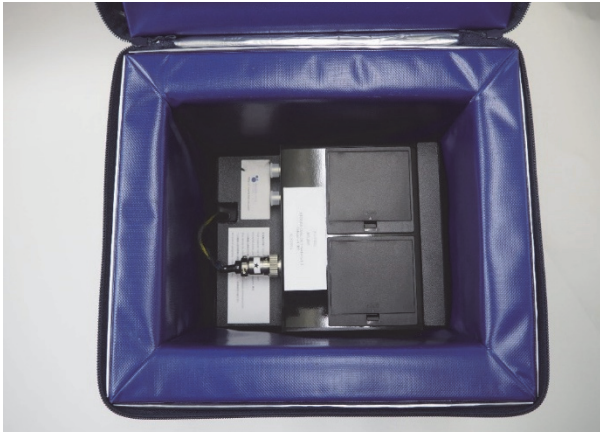
図VII-5 Bio-Box Cell 発泡ウレタン製の厚いカバー内に輸送器(エレキセル)が収められる
