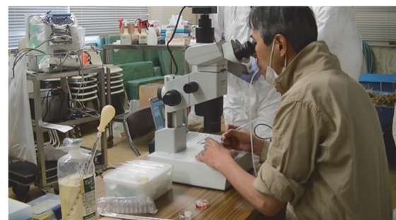
図VI-9. 実体顕微鏡によるろ過した回収液から卵子の検索
