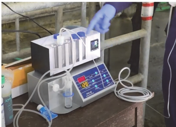
図V-4. 吸引装置(下)と保温装置(上)および2つ並列した遠沈管
