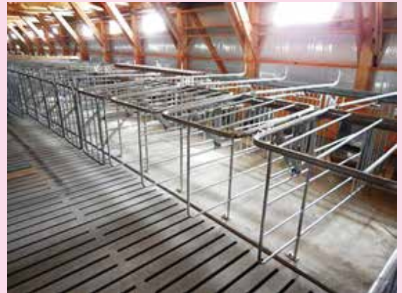
豚が中に入るとストールの後ろが閉まり、他の豚が中に入れないようになっている
