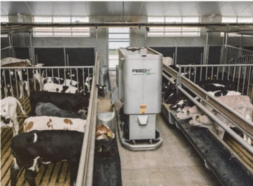
図 5-3 自動給餌作業中の FEEDR<sup>®</sup> Feeding robot
