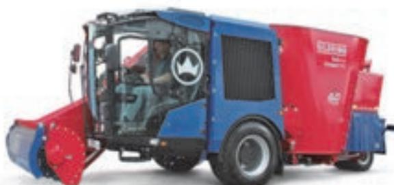
的な 105kW (143 hp) のボルボ 4 気筒ターボディーゼルエンジンを搭載。129 kW (175 馬力) または 160 kW (218 馬力) のオプションのパワーパックがある。
