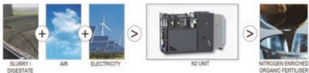
図 14-1 スラリー改質装置「N2 Unit」の外観及び処理プロセス (N2-Applied 社 HP 引用)
