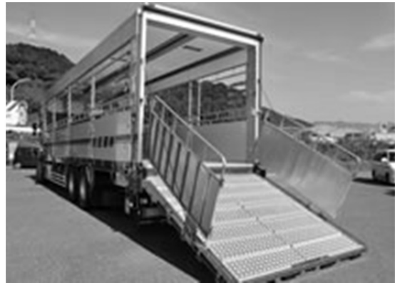
事例 2：傾斜部分に滑り止めや落下防止柵を設置
