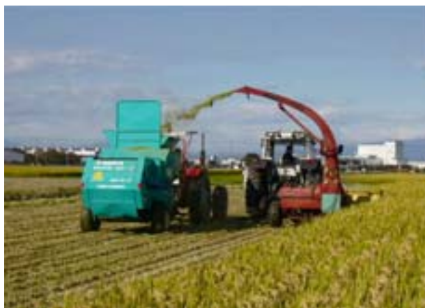
図6 細断型ロールベアラによる収穫
