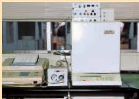
写真-23 ガスクロマトグラフィー (GLサイエンス製GC-380)
