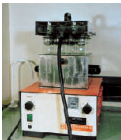
写真-9 加熱分解装置 (Tecater Digestion System20)
