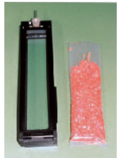
写真-28 高水分・高脂肪用大型セル
