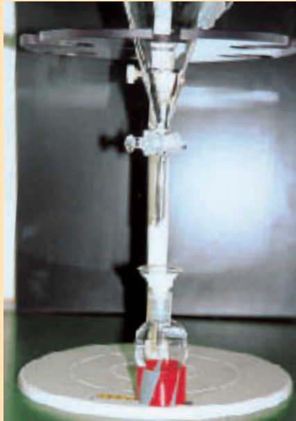
写真-22 硫酸ナトリウム(無水)を満したロートを通して下層(クロメタ層)をフラスコに移す
