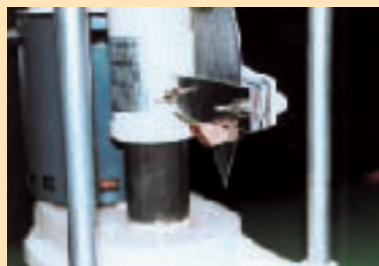
写真-17 サンプルの切断このときの最大抵抗を剪断力価とする
