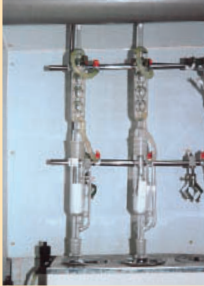
写真-8 ウォーターバスで16時間(以上) 還流させる
