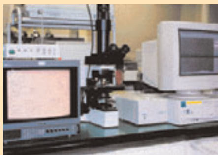
写真-30 顕微鏡と画像解析装置を接続
