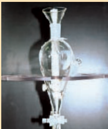
写真-21 分液ロートにロートを用いて生食を入れておく
