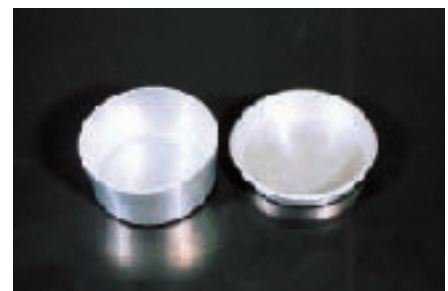
写真-5 水分分量測定用アルミ製カップ
