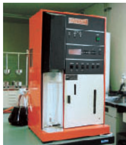
写真-10 窒素蒸留滴定装置 (Tecater Kjeltec Auto1030 Analyzer)
