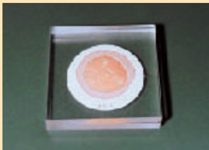
写真-20 加圧後、肉片の輪郭を描く
