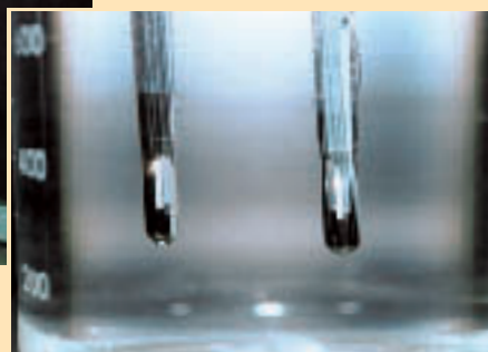
写真-26 毛細管を融点用毛細管に取り付けホットスターラーで徐々に加熱する
