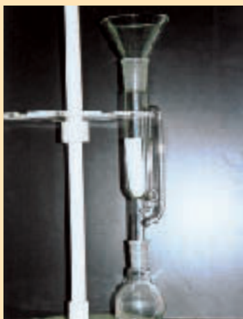
写真-7 ロートを通じて水分含量測定後の乾燥サンプルを円筒濾紙内へ入れる
