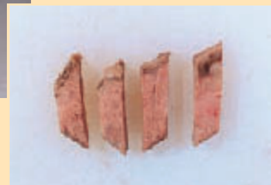
写真-15 剪断力価測定用サンプルの切り出し
