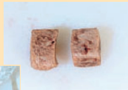
写真-13 冷却後のサンプルの汚れを流水で軽く洗い流す
