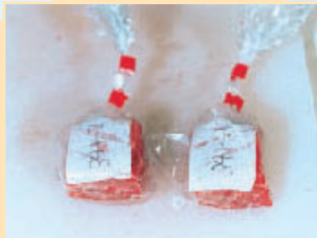
写真-12 サンプルをビニール袋に入れ、水が入らないようにしぼる
