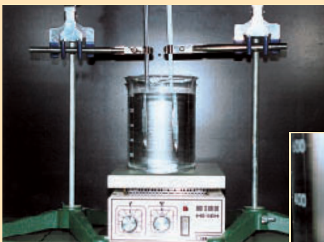
写真-25 融点用毛細管に加熱抽出した脂肪を吸い上げる
