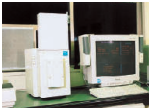
写真-27 近赤外線分析装置(ニレコ製6500)
