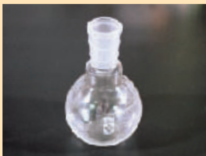
写真-6 粗脂肪分量測定用ソックスレー抽出ビン
