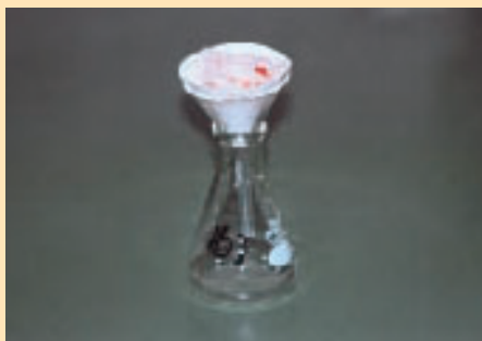
写真-24 脂肪を細切し、濾紙を敷いたロートに置くこれを加熱抽出し、三角フラスコで受ける
