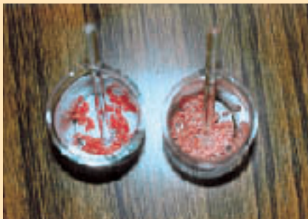
写真-4 サンプルと水砂を混合する 左：混合前、右：混合後
