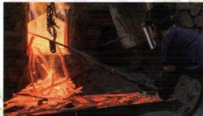
状態を確認しながら炭を掻き出す作業は明け方までつづく。
